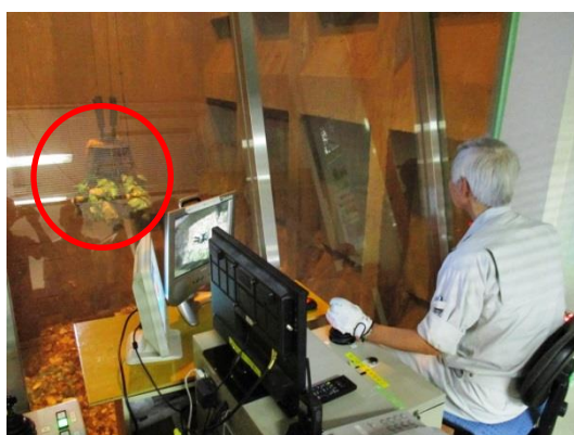
↑ クレーン室で じ ゴミクレーンを そうさ 操作する しよくいん 職員 (左がわにクレーンが見えます)
